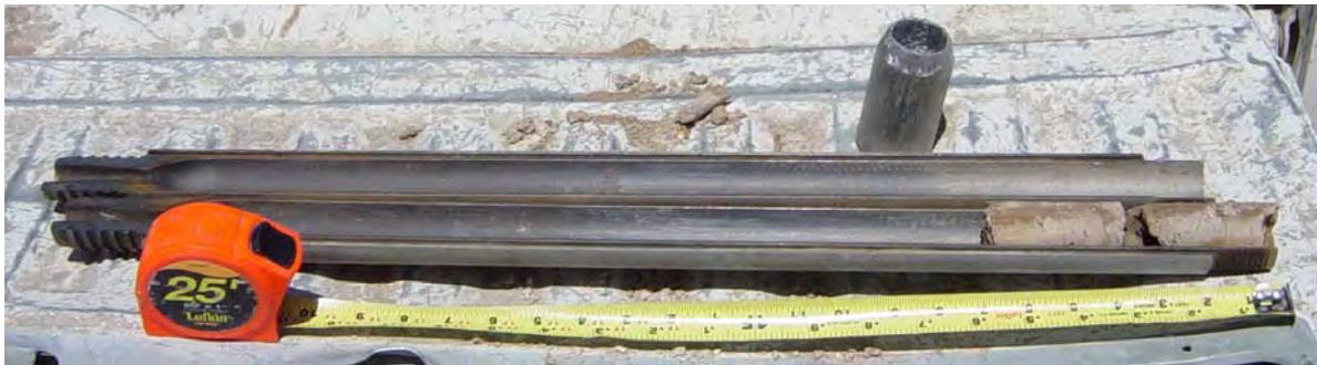
**Figure 3-8. Split barrel sampler.**
